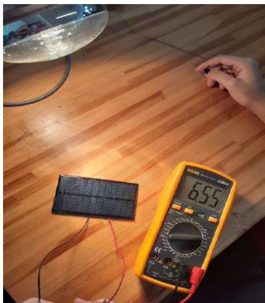
Figuras 9 e 10: Testes de voltagem da placa solar.
