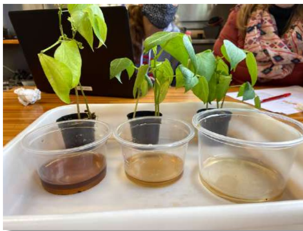
Figura 6 — Resultado da drenagem Pote 1: Solo orgânico úmido; Pote 2: Solo orgânico seco; Pote 3: Solo rochoso.
