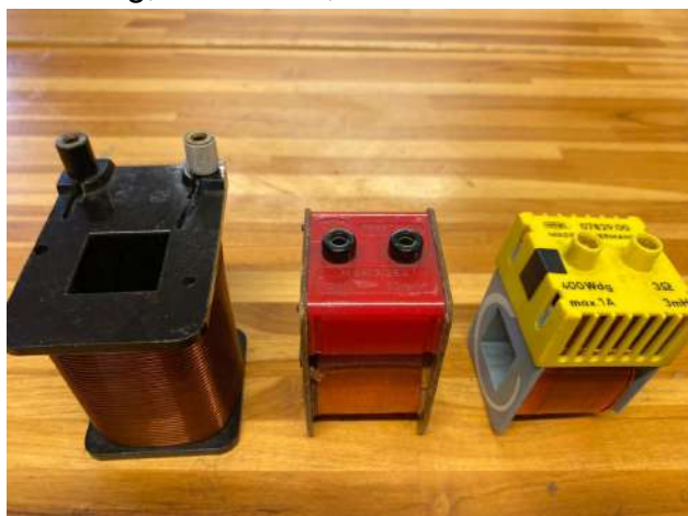
Figura 8: Bobina preta, vermelha e amarela, respectivamente: 250 Wdg, 1600 Wdg e 400 Wdg.
