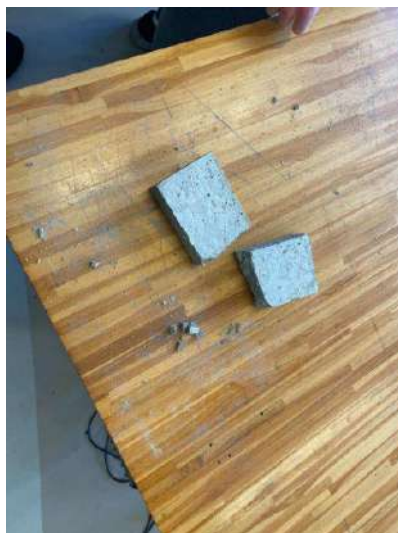
O tijolo do grupo não resistiu a uma simples martelada
