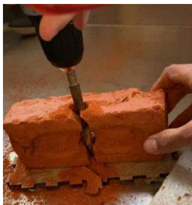
O tijolo de barro quebrou com a furadeira
