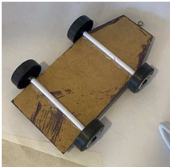
Figura 4: visão da parte de baixo do carrinho, mostrando os canudos de papel que cobrem os eixos
