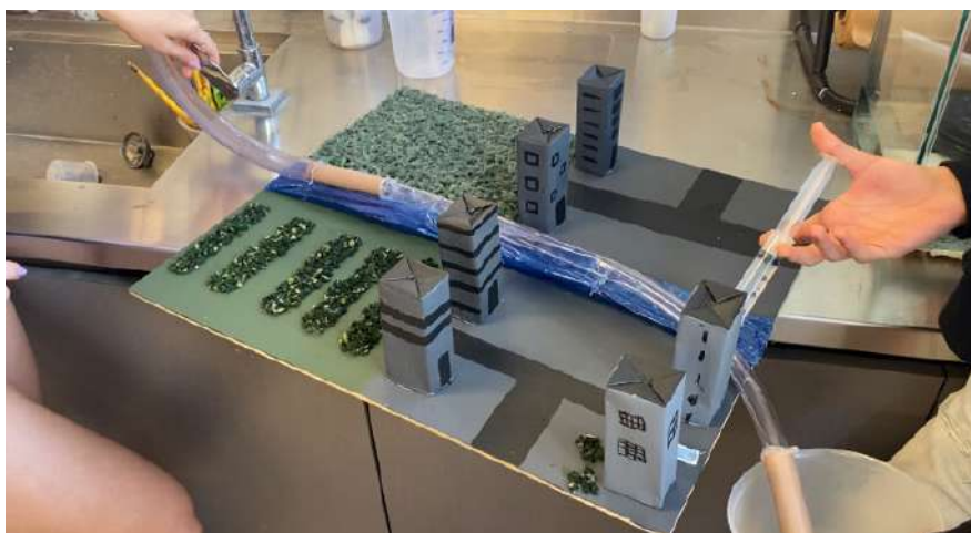
Figura 24: Teste com a mangueira recebendo fluxo de água da torneira somada com a água da seringa
