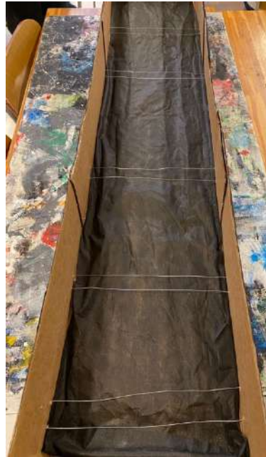
Figura 5: caixa de papelão que serviu de base para o terreno do experimento forrada com TNT
