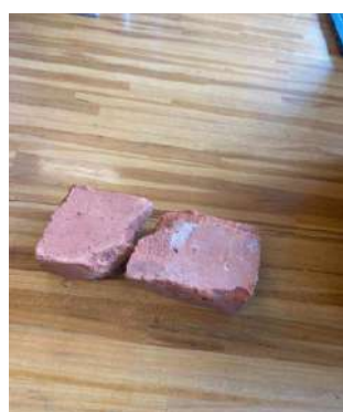
O tijolo de barro não resistiu a uma martelada
