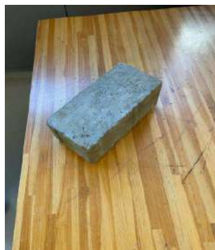
O tijolo industrial resistiu a uma martelada
