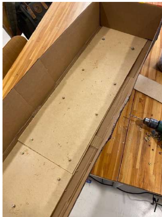
Figura 6: caixa de papelão com a parte de baixo reforçada com madeira
