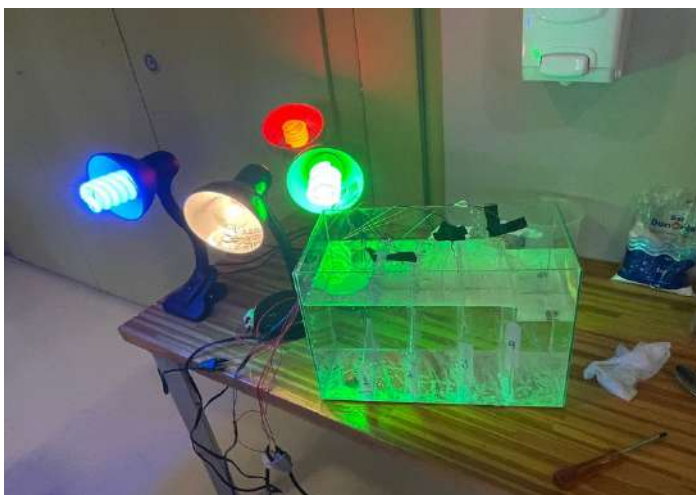
Figura 3: aquário preenchido com água, e condutivímetro provocando o acendimento das lâmpadas de cores branca, vermelha, verde e azul.
