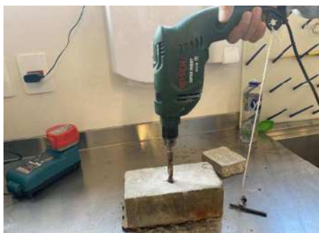
O tijolo industrial resistiu a furadeira
