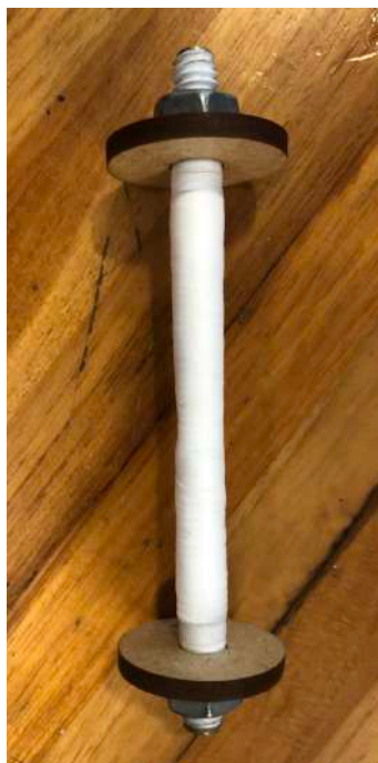
Figura 13: Parafuso com a fita veda rosca, as porcas metálicas e as roscas de MDF.
