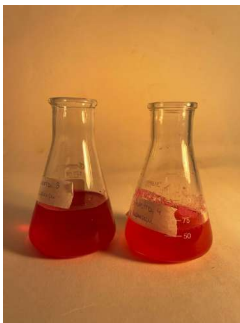
Figura 32: Amostras que continham casca de cupuaçu após a filtração. Na esquerda, o teste de 2g de casca e, na direita, o de 6g (Foto tirada pelo grupo, 2022).
