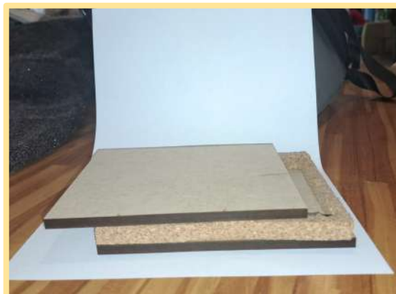
Figura 4 - Mini compressor feito para modelar e comprimir os testes iniciais (e menores) da madeira plástica. Este é composto de madeira mdf e uma fina camada de 1cm de cortiça que o limita, ambos medindo 11x15cm.
