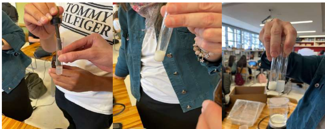
(Imagens 8,9 e 10- reação do nitrato de prata(imagem a esquerda), formação do sólido(imagem ao meio) e comparação entre a água potável e a salgada(imagem a direita))
