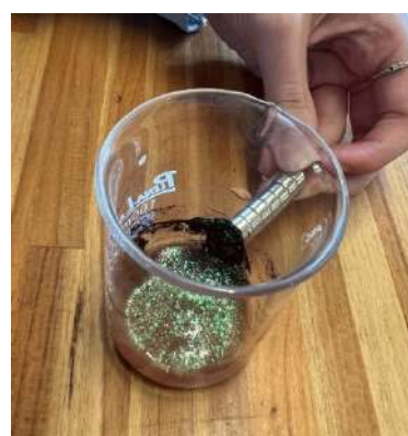
Figura 4. extração do micro plástico na amostra de água manipulada (nível 4).
