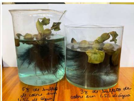
Figura 12. Béqueres contendo 5g e 3g de sulfato de cobre respectivamente em 1,5 L de água contendo uma amostra de água-pé em cada após uma semana, com as plantas já mortas ]
