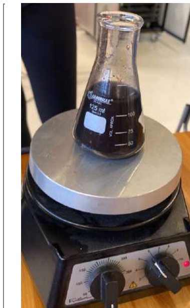
Figura 14: Agitação da amostra I no agitador magnético (Foto tirada pelo grupo, 2022).
