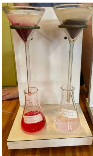
Figura 26: Filtração das amostras com carvão ativado (Foto tirada pelo grupo, 2022).
