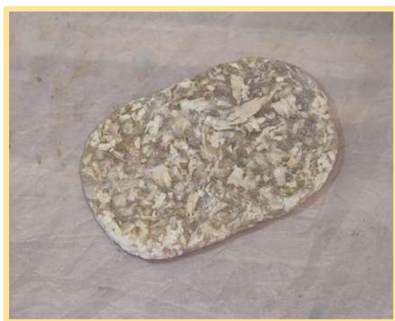
Figuras 7 e 8 - A primeira imagem apresenta o segundo experimento, feito com uma quantidade maior de material, antes do teste de resistência, enquanto a segunda mostra o protótipo após o teste em questão, quebrado.
