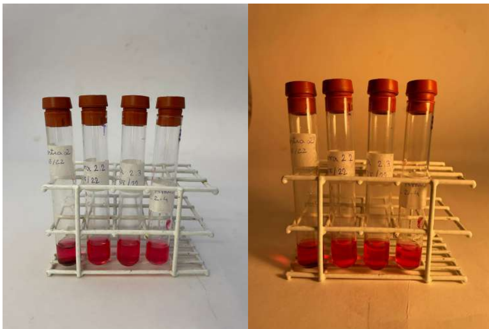
Figuras 29 e 30: Amostras da substância que continha 4g de carvão ativado ao longo dos dias e agitações (iluminação natural e artificial, respectivamente) (Foto tirada pelo grupo, 2022).
