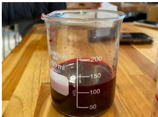
Figura 12: Mistura de água acidificada, 1,5g de corante reativo e 20mg de carvão ativado (Foto tirada pelo grupo, 2022).
