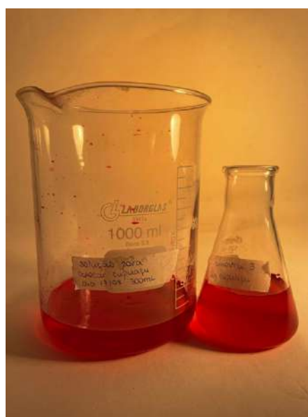
Figura 34: Comparação amostra 3 (2g de casca de cupuaçu) com a substância controle, sem adsorvente (Foto tirada pelo grupo, 2022).
