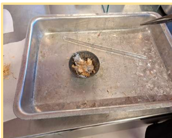
Figura 5 - Amostra de plástico deformado pelo calor do soprador no primeiro teste. Na foto, a amostra encontra-se no pequeno recipiente de alumínio.
