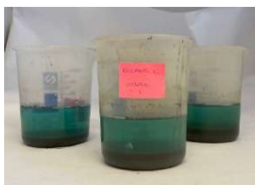
Imagem 1.1: três béqueres de água com \text{Cu}^{2+} . Nessa imagem, há a separação e sedimentação do material
