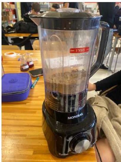
Figura 18: Pedacos da casca de cupuaçu sendo triturados no liquidificador (Foto tirada pelo grupo, 2022).
