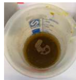
Imagem 2.3: um béquer de água com \text{Fe}^{3+} . Nessa imagem, já é possível identificar a separação e sedimentação do material sólido do líquido.
