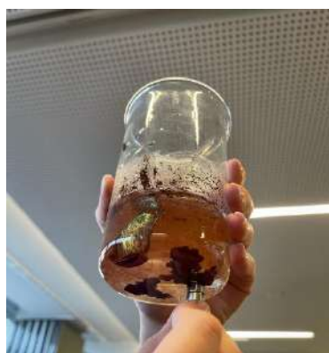
Figura 3. extração do microplástico com superimã na amostra de água pura (nível 3).
