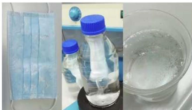
Figura 2: experimento de análise de microplásticos e nanofibras emitidas por máscaras no processo de decomposição da máscara cirúrgica em contato com a água do mar (Fonte: SALIU et al., 2021).
