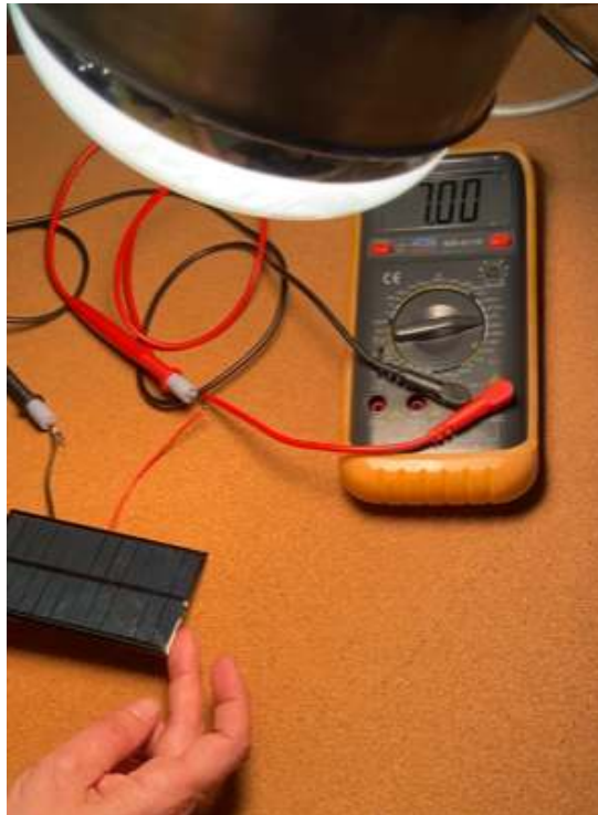
Multímetro medindo voltagem da placa.
