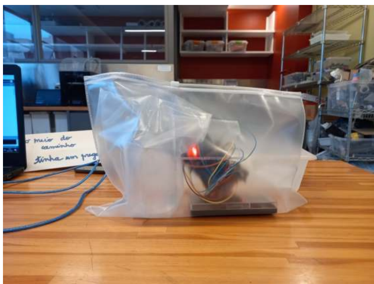
Figura 7: Sensor medindo a atmosfera da estufa de 100% de \text{CO}_2
