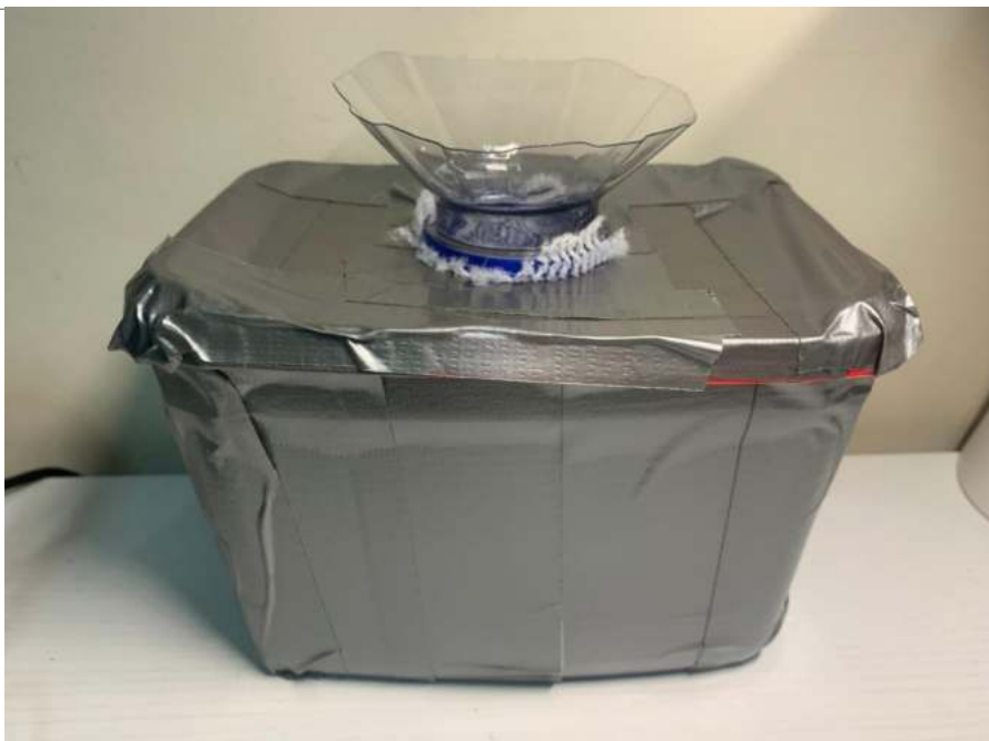
Imagem 9: Sistema com a fita isolante térmica grudada.
