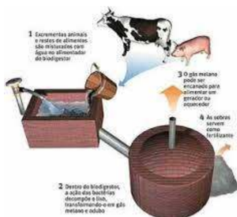
Imagem 4 - Processo de obtenção do Biogás
