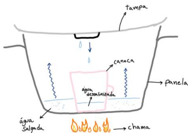
Imagem 1: Esquema mostrando a dessalinização utilizada para o experimento
