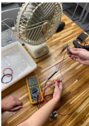
Legenda: Ventilador soprando vento no protótipo, que está gerando energia
