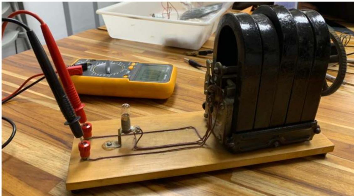
Figura 10: dínamo, lâmpada incandescente, fios conectados ao mecanismo e multímetro
