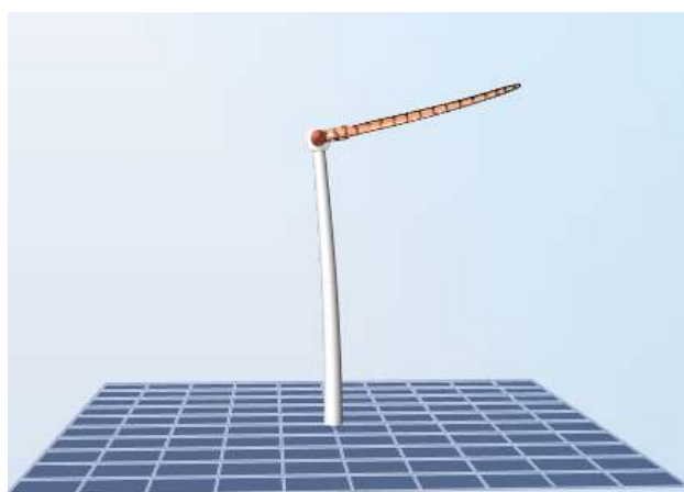
Figura 13: Imagem do aerogerador com apenas 1 pá quando está em operação. Observa-se que sua torre está torta
