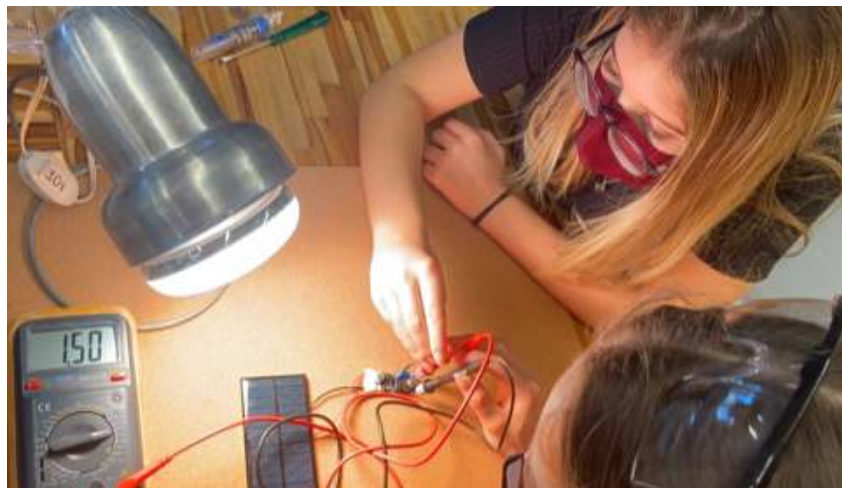
Regulando a tensão para 1,5 volts
