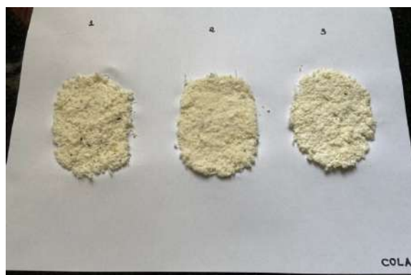
Figura 13 – amostras feitas com fibra de cana-de-açúcar, água e cola vegetal
