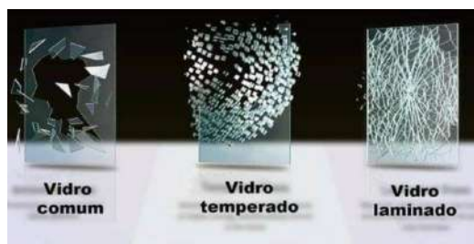
FIGURA 2 – Vidro temperado e vidro laminado, comparação
