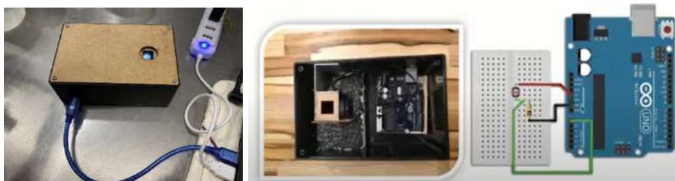
Figura 8. Sensor de Turbidez (fechado e aberto) e desenho esquemático do circuito do Arduino
